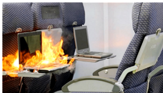
Fig. 5 : Lithium battery fire
